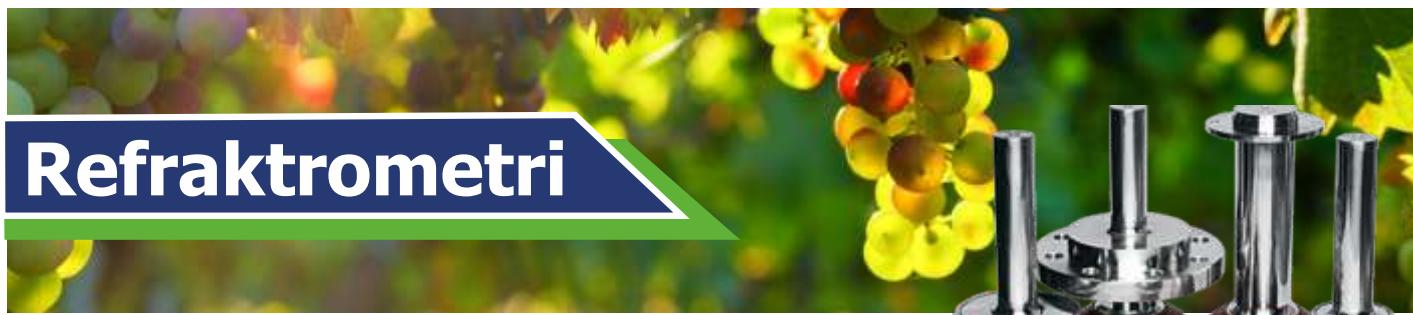
Refraktometar je merni uređaj za određivanje indeksa prelamanja tečnih i čvrstih transparentnih materijala. On za to koristi ponašanje svetlosti na prelazu između prizme sa poznatim osobinama i materijala, koji se ispituje. Ako je poznat sastav tečnosti, refraktometar može meriti koncentraciju rastvorenih materijala.
