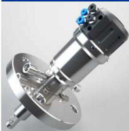
Pneumatski pogonjeni izmenjivi fitinzi **mogu se priključiti na procesne rezervoare ili cevi**. Pogonska jedinica spušta senzor u procesni medij i nazad u komoru za čišćenje.
